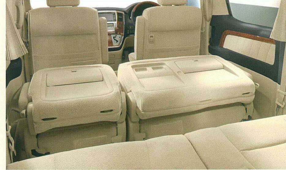
8人乗り セカンドシートは6:4分割式、サードシートは5:5分割式。ともに大人3人がゆったりくつろげるスペースを確保。セカンドシートはロングシートスライド機構(最大570mm)、リクライニング機構、回転機構付。サードシートは7人乗り同様、ロングシートスライド機構、リクライニング機構を備えたスペースアップシートが装備されています。
