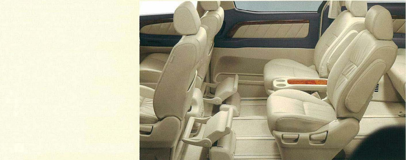
7人乗り セカンドシートにはアームレスト付のキャブテンシートをご用意いたしました。ロングシートスライド機構(最大550mm)、リクライニングはもちろん、オットマンを備えたシートのほか、回転機構を備え、対面が可能なシートも設定。もちろんサードシートへの移動(ウォータースルー)も難なく行えます。サードシートはロングシートスライド機構、リクライニングに加え、5:5分割式で横にはねあげることができます。大きなラゲージスペースが生まれるスペースアップシートとなっています。
