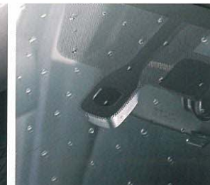
■雨滴感知式ウォッシャー連動間欠フロントワイパー ※写真はセンサー部。
