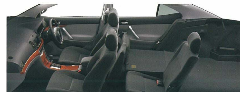
リヤシートバック片側可倒+クッション引き起こし状態
