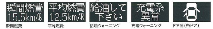
瞬間燃費 平均燃費 給油ウォーニング 充電ウォーニング ドア開(各ドア)
